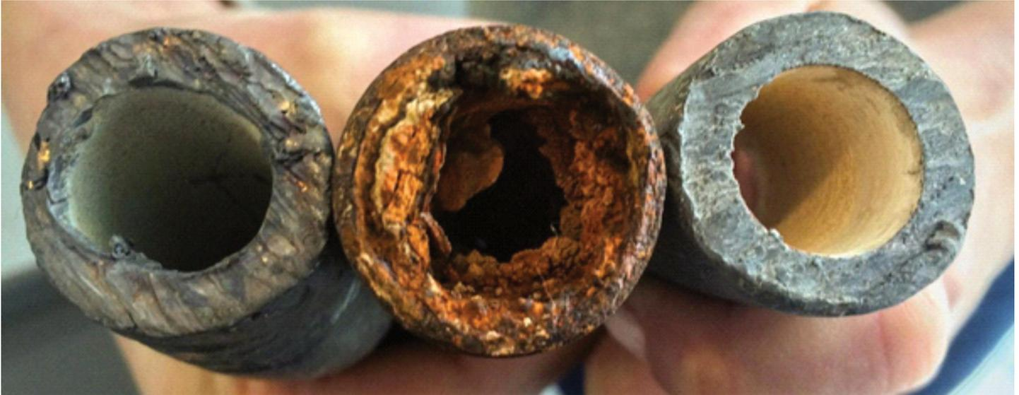
Ein Querschnitt von drei Rohrleitungen, wobei das mittlere Rohr von einem rot gefärbten Biofilm befallen ist. Die rote Farbe wird durch Eisenpartikel verursacht, die natürlicherweise im Wasser vorkommen. Die im Biofilm vorhandenen Bakterien nutzen die Eisenpartikel für den Sauerstofftransport (Quelle: University of Arkansas).
